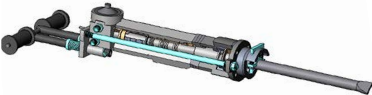
1-сүрөт. Тоо-кендерин урма-бурулма ыкмасы менен бургулоочу гидравликалык перфоратор Рисунок 1. Гидравлический перфоратор для ударно-поворотного бурения пород
