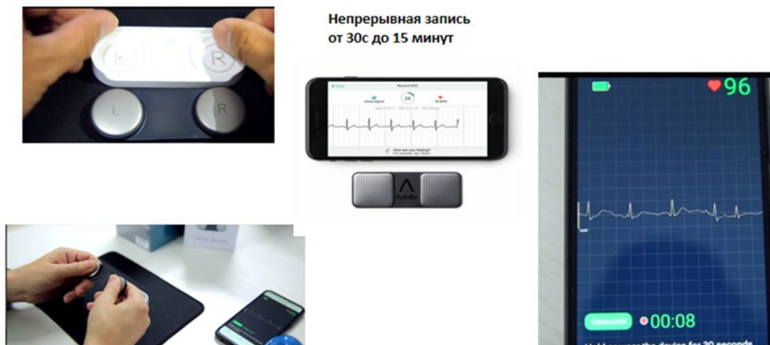
Рис. 1. Одноканальный мобильный кардиограф используется для снятия ЭКГ с пальцев рук с последующей передачей сигнала через смартфон в центр для спектрального анализа.
